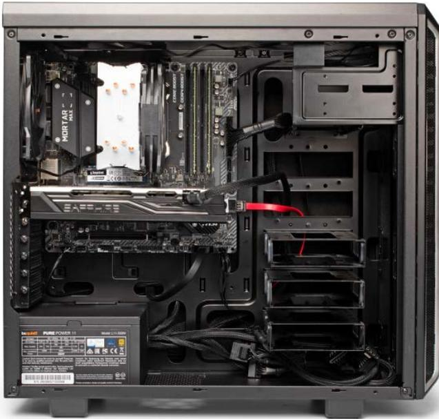
Unser Ryzentosh basiert auf dem Allrounder-Bauvorschlag mit AMDs Sechskern-CPU Ryzen 5 3600 auf einem B450-Mainboard mit 16 GByte RAM, einer NVMe-SSD und der Sapphire-Grafikkarte Pulse Radeon RX 570.
