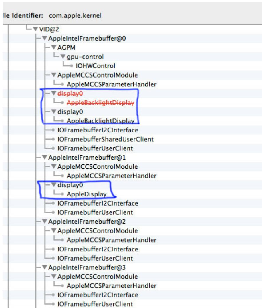
Oben sehen wir das interne Display am Framebuffer 0, direkt darunter ist der externe Monitor am Framebuffer 1 aufgetaucht.
