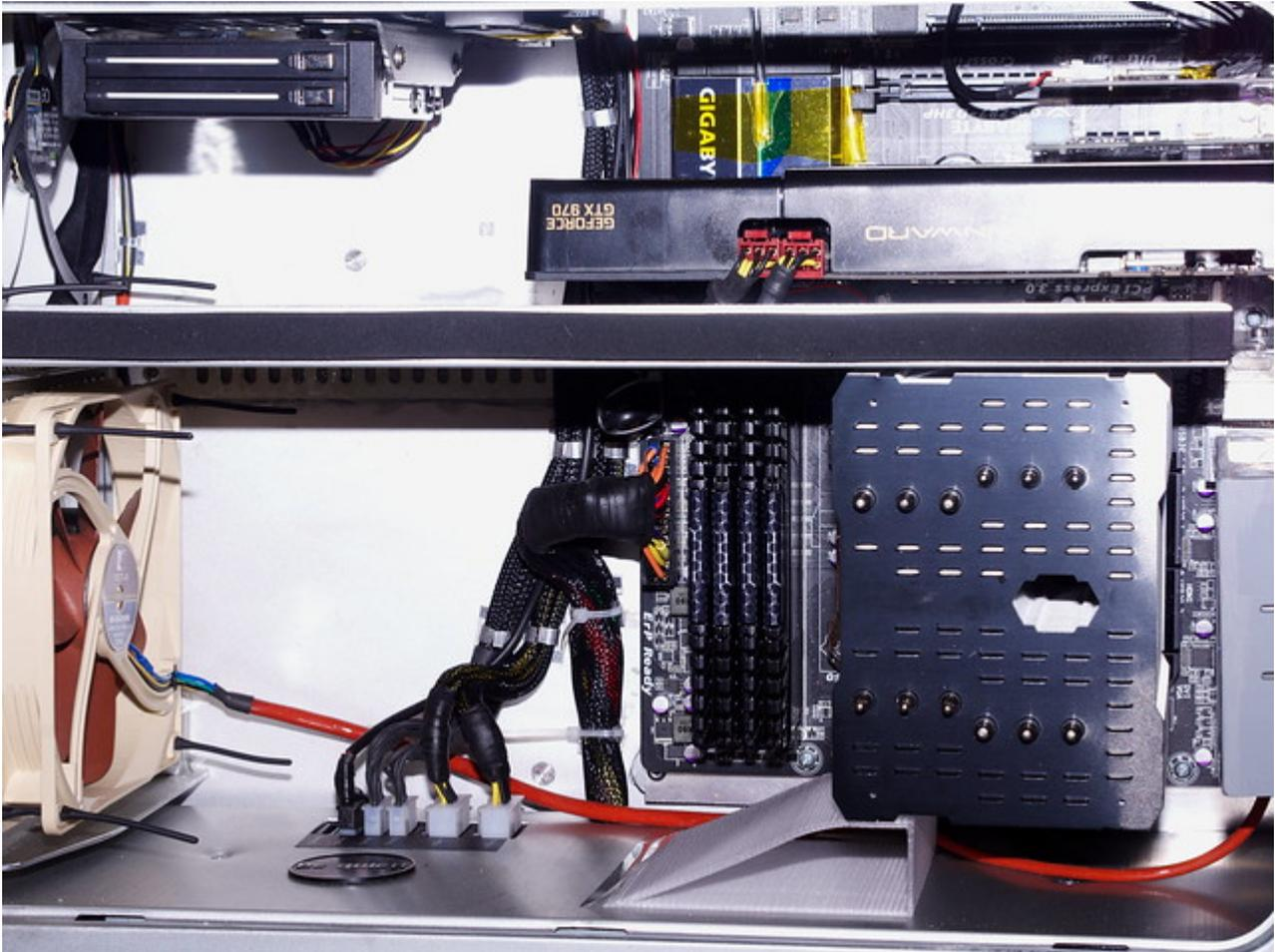
Ich hab das Innenleben in zwei Thermozonen unterteilt, der schwarze Steifen mittig ist eine Fenster-/Türdichtung, die an nem Alu-Trennblech angeklebt ist, die Dichtung steht bei geschlossenem "Deflector" dort an und trennt oben von unten.
