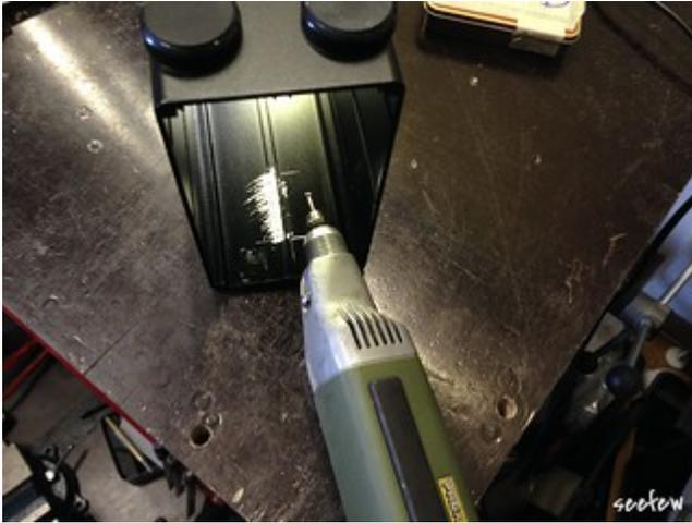
Da der PCIe-Stromanschluss im geschlossenem Gehäuse nur sehr wenig Platz hat, bin ich etwas mit dem Proxxon zu Werke gegangen.
