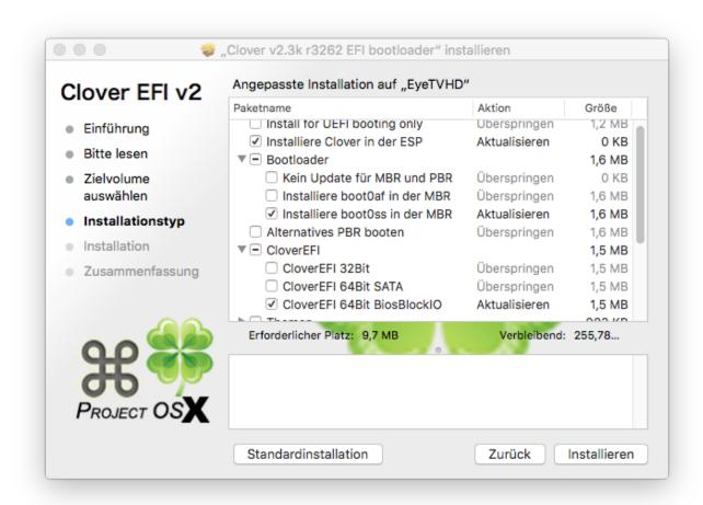
BIOS Block funktioniert mit allen im BIOS erkannten Festplatten, SATA nur mit den internen SATA-Ports auf der ersten BIOS-Ebene und nicht mit zusätzlich eingebauten und auch nur selten mit USB-Platten, die das BIOS als extern erkennt..
