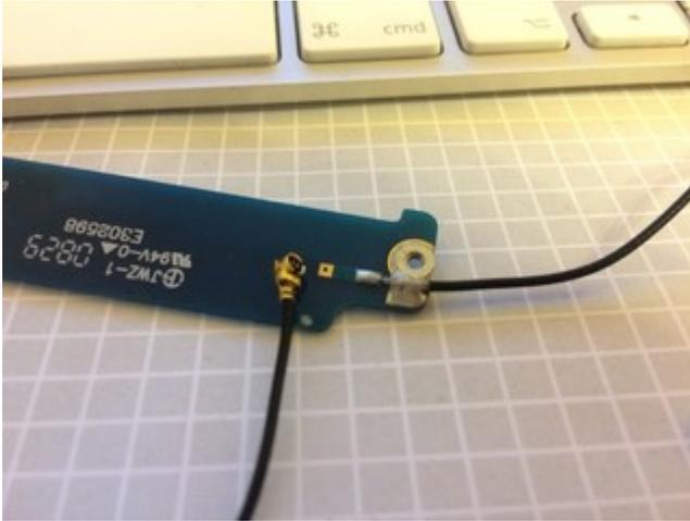
Der Innendurchmesser am Anschluss ist etwa 2mm. Die WLAN Antennen haben den gleichen Anschluss.
