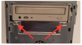
Die ganze Einheit mit DVD-Laufwerk und ZIP-Laufwerk (sofern letzters bei Eurem Mac verbaut wurde) wird nur von den beiden Schrauben an der Vorderseite gehalten und ruht im Inneren in den entsprechenden Schienen. Aber mit der Ruhe ist es ja nun vorbei 🥌
