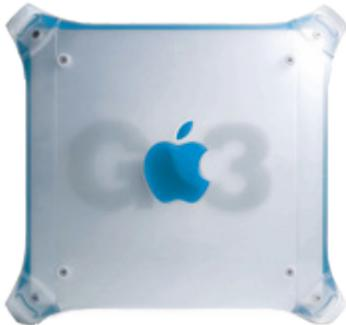
Du brauchst einen Trafo, ein Board, eine CPU mit Grafik, Arbeitsspeicher, mindestens eine SSD für's System, die Snow-Leo-System-DVD von Apple, neun kleine 1cm-hohe Hutmuttern, ne Metallsäge, einen 2er Inbus-Schlüssel und viele lange Kabel..
