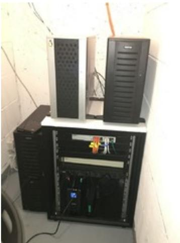
Aufgaben sind neben dem Bereitstellen von Daten (NAS quasi) per Samba und NFS primär die Funktion als Streaming Server. Eine 8x DVB-S2 Sat Karte (Digital Devices Max S8) ist hier verbaut und streamt und zeichnet TV-Programme auf (meine Frau und ich sind große Fans von Dokus ;)). Der Stream wird im Haus per IP verteilt. Clients sind Raspberry Pi 3 mit OpenELEC/Kodi. Die Sat-Kabel habe ich mittlerweile aus den Leerrohren entfernt und werde dort in Zukunft lieber Cat7 Kabel verlegen.
