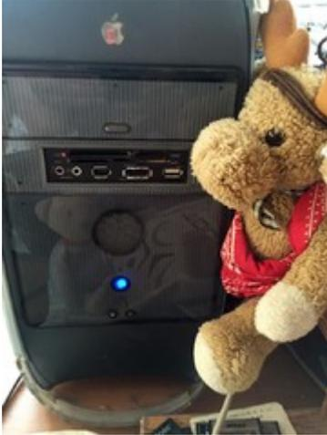
Blink-Lampe, Slot-in-Laufwerk und SSD-Fach hinter der Klappe, Card-Reader und Stecker-Panel, Lautsprecher, Hauptschalter mit LED und Reset-Schalter sind das von Oben nach Unten..
