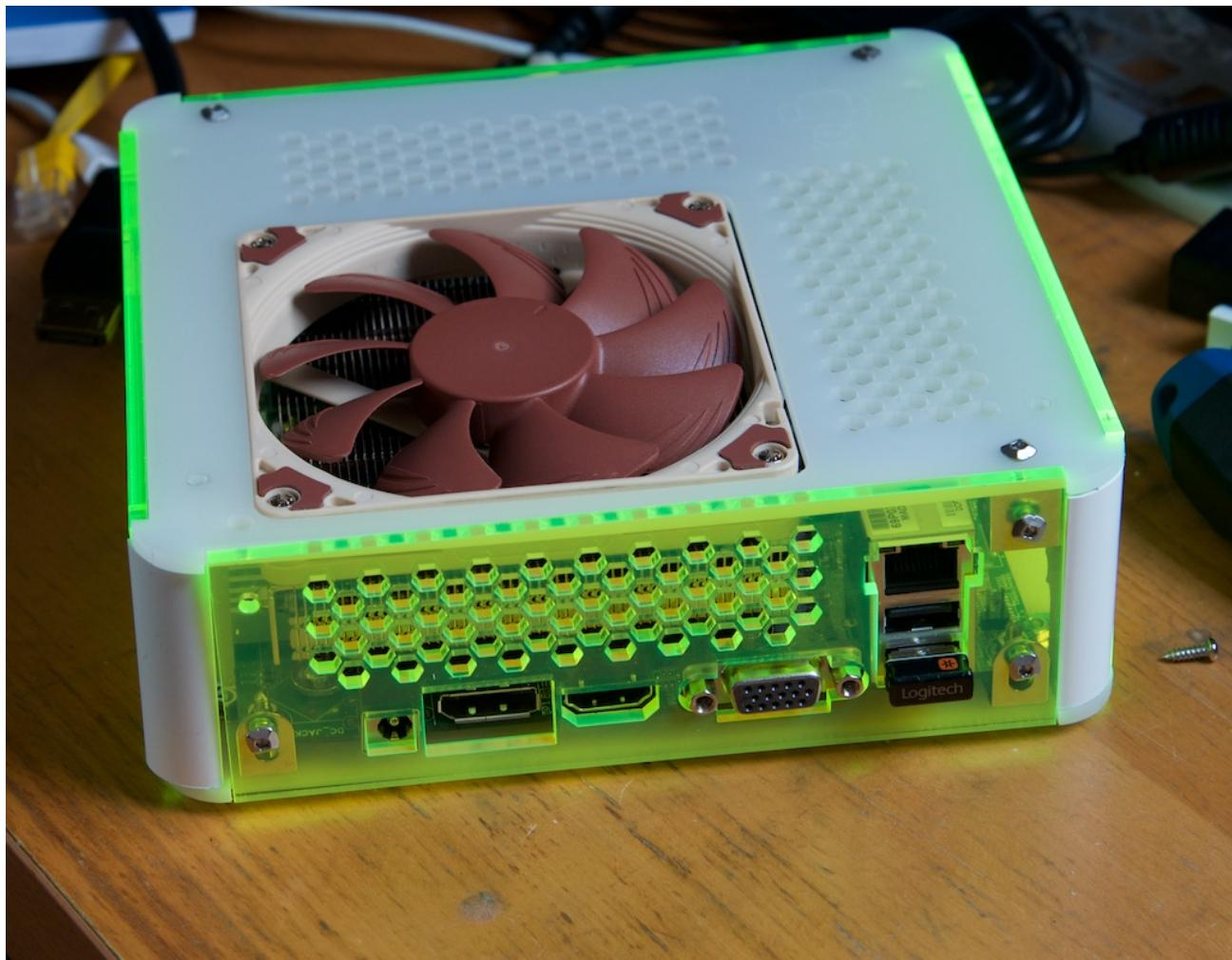
Von links Power, DP, HDMI, VGA, Ethernet und 2x USB.
