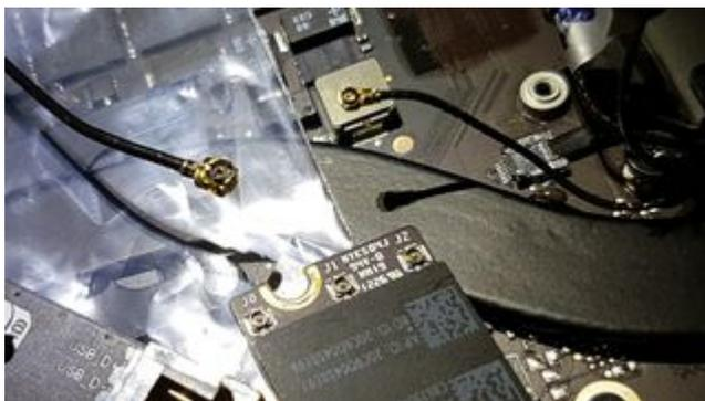
links: Anschluss Antennenkabel PCI-e Adapter
