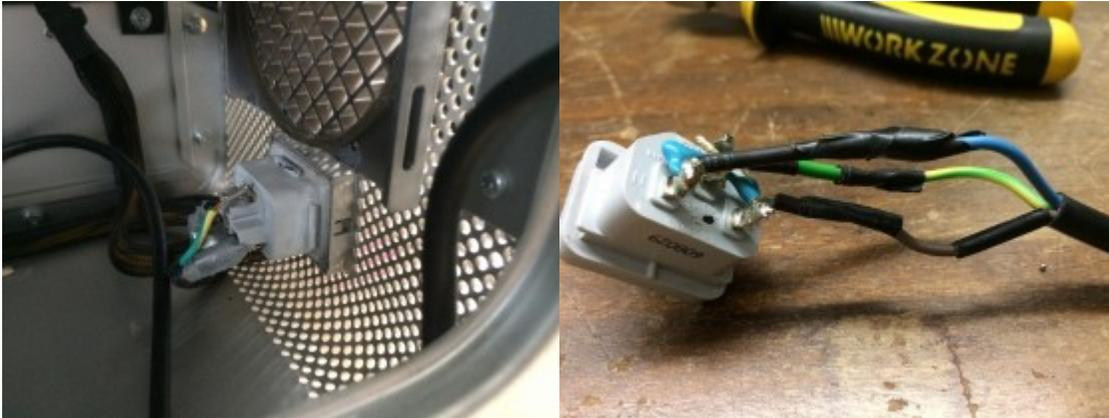
Die Lötstelle beim G5 war schon nicht so dolle (auch wenn es nur Masse/Erdung ist) - das Isolierband beim MP-Stromanschluß, bei dem man schon erkennen kann, dass es nicht dicht ist, ist genau so wenig sicher wie die Lötstellen gut ausschauen. Und auch hier wieder: Kein Isolierband, sondern Schrumpfschlauch verwenden!
