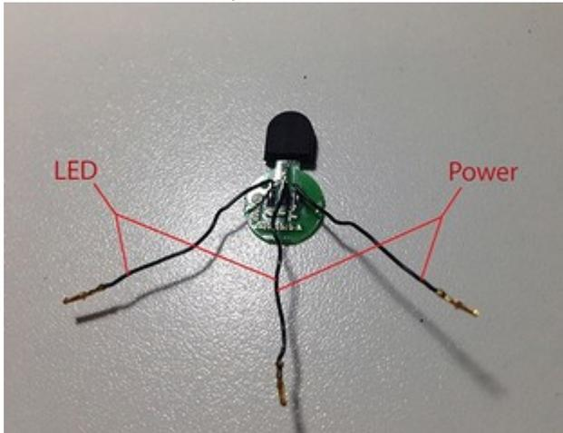
Das rechte Kabel ist das + und die Mitte die Masse, LED und Schalter teilen sich die Masse. Ist zwar vom PowerMac G5, aber ich bezweifel das sie da was geändert haben, da dein Powerknopf genauso aussieht.
