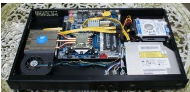
Wie aus der Zeichnung im Intel-Heftchen zu sehen, gibt es im Original eine Aussparung für die CPU-Sockel-Gegenplatte unter dem MB. Ich habe die große Epox-Platte etwas höher gesetzt und zwei schmale Epox-Streifen als Distanzhalter angeklebt. Wegen der kurzen Rändelschrauben an der Spinne und mangels Eindreh-Gewinde musste ich mit 2K-Kleber Muttern auf den Isoliernippeln mit der Epox-Platte verkleben. Die roten Isolierscheibchen waren wegen der auf dem MB aufliegenden Metallmuttern notwendig.
