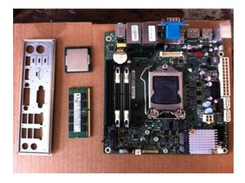
ein fujitsu D3434-S, H110 chipsatz, dazu ein i7 6700T und erstmal 8GiG ram (kommt geld, kommt mehr ram...). das board kann auch direkt mit 12V gefüttert werden, ein 72watt netzteil gabs dann auch noch dazu.
