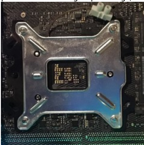
Das Halteblech und die Gummiunterlage - fast gut.
