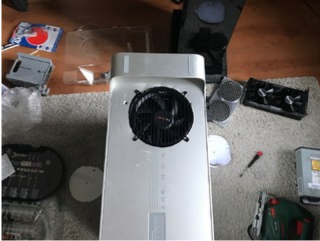
Rückseite vorbereitet und Cutouts angezeichnet
