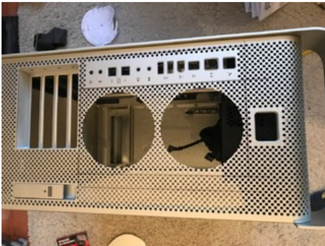
Aus diesem Blech habe ich die neue Rückblende selber zusammengebastelt
