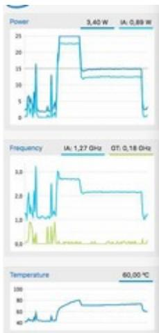
IntelPowerGadget zeigt uns bei allen Tests, dass bessere Ergebnisse durch Throttling verhindert werden. Man sieht in dem Screenshot sehr schön wo das Throttling einsetzt.
