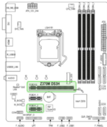
Der lange Slot (PCIEX16) ist für die Grafikkarte und der untere kleine Slot (PCIEX1\_2) ist für die Combo-Karte...
