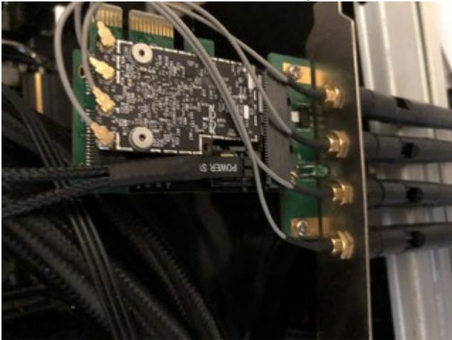
Auf dem zweiten sieht man den Anschluss der WLAN/BT Card von ASUS und von dem "altem" Adapter.
