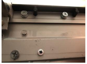
Und hier die Alu-Leiste, an die später das ausgeschnittene Lüftergitter geklebt werden soll:
