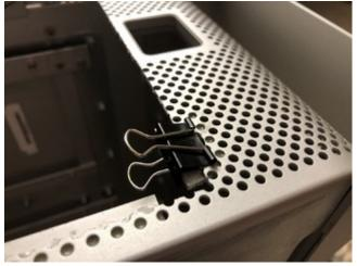
Es ist gar nicht so leicht passende Positionen für solche Befestigungen zu finden. Der eigentliche Kühlergrill, der mit der Rückseite verschraubt wird, ist fast so groß wie das herausgeschnittene Teil. Ich hoffe, dass die wenigen Verbindungen ausreichen, damit die Rückwand stabil wird.
