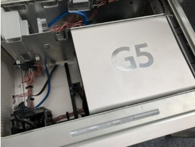
Und zuletzt noch die vorderen CPU-Lüfter. Die Steckbuchse habe ich so positioniert, dass man die Lüftereinheit wie beim Original noch relativ problemlos herausziehen kann:
