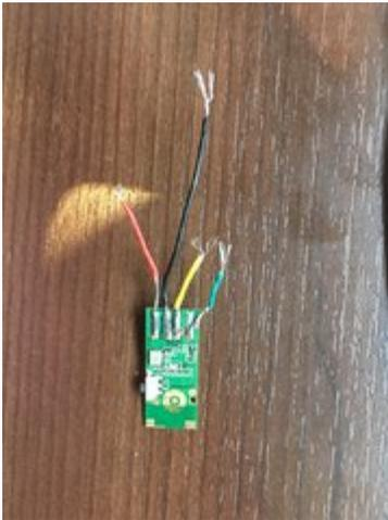
So ist aufgrund meiner komischen Kabel die Belegung. Aber achtung. Nur der Rote ist die genormte Form. Alle anderen Farben passen nicht zu der offiziellen Pin Belegung.
