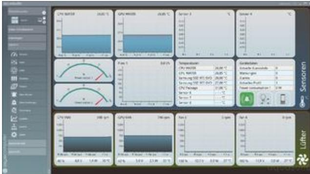
An der Aquero hängen an Fanport 1 sechs 140er Lüfter (push/pull) für CPU- und an Fanport 2 sechs 140er Lüfter (push/pull) für den GPU Kreislauf.
