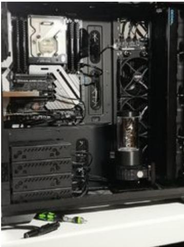
Bis auf die beiden GPUs und den Radiator im Deckel ist alles eingebaut und größtenteils vorverkabelt.
