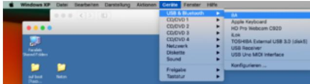
so, habe die iCue-Software unter Parallels wieder ans laufen gebracht. Parallels findet die Wasserkühlung nur wenn der Connector des angeschlossenen USB-Ports auf "USB2" steht. Zur Ansteuerung also nun eine separate .aml erstellt. Unter MacOS muss der Connector auf "intern" stehen, damit der Ruhezustand funktioniert.
