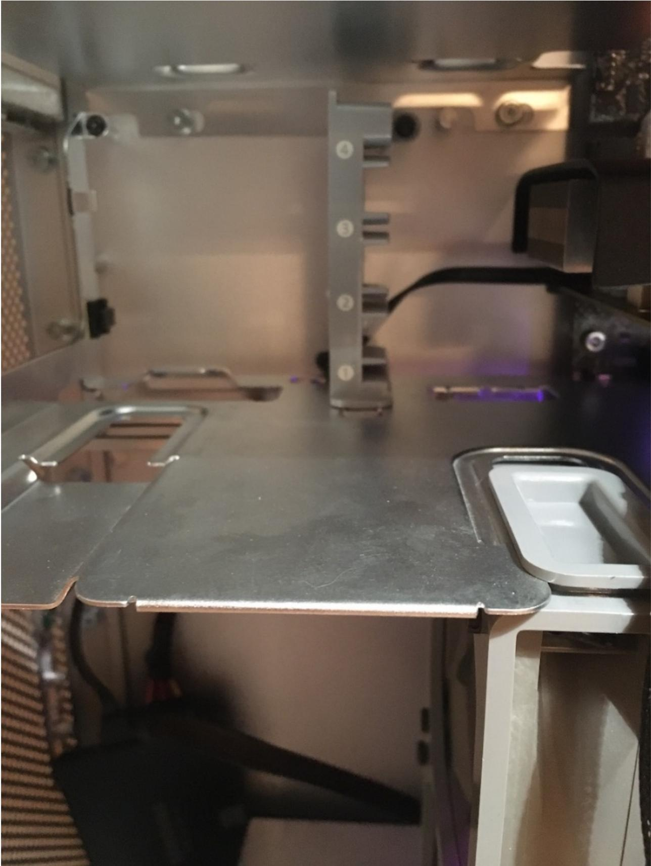
Auf der Motherboardseite wurden 3 Winkel angefertigt, welche mit Distanzhülsen mit dem Motherboard verschraubt sind. Der Winkel ist mit einer 2mm Senkschraube am Blech verschraubt.
