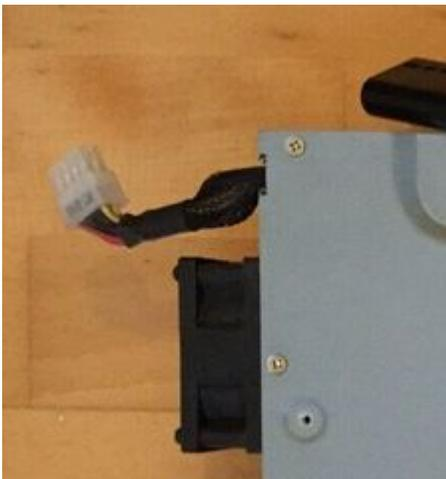
Da wird im G5 das flach liegende Stromversorgungskabel für SATA & Molex aufgesteckt, was nach oben führt. Ich brauche das als Gegenstück zum G5-SATA-Kabelbaum.
