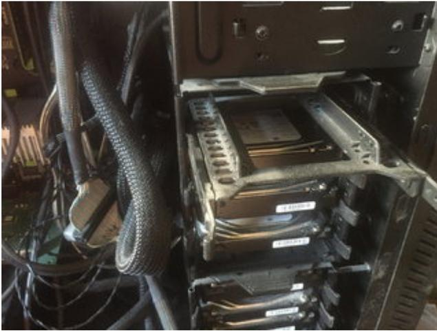
Die seitlichen Einschübe - oben noch ein leerer Platz mit den clipbaren Schienen (ohne Schrauben an den Festplatten draufzusetzen) und dem 2.5" Adapter...
