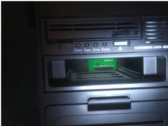
vorne zugänglicher Einschub, nackte Platte ohne Schrauben etc einschiebbar...
