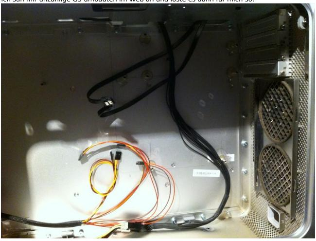
Alles raus und die Nippel an das Motherboard geschraubt. Zweikomponenten Kleber an die angerauten ungefähren Positionen üppig aufgetragen. Danach das Board in den Kleber gestellt und mit einer gesteckten Karte ausgerichtet. Am nächsten Tag konnte ich die Schrauben lösen und das Ergebnis für gut befinden.
