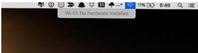
Ich hab also das WLAN/ Bluetooth Modul ausgetauscht, leider immer noch keine WLAN. Aber Bluetooth funktioniert, und hat auch beim alten Modul funktioniert, auch unter HighSierra. Ich kann mir das nicht erklären, auf dem Modul BCM94360CS2 ist doch WLAN und BT drauf.... Wenn beides nicht funktionieren würde, könnte ich den Fehler eingrenzen, aber so. Ich kann das BCM94360CS2 leider nicht wo anders testen, auf meinem Hacki hab ich keinen Adapter dafür. Was meint ihr?
