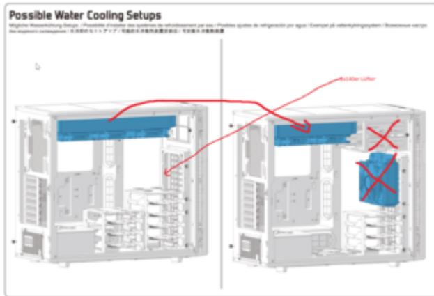
360er oben mit Luftstrom nach außen, Front unter der Frontverkleidung zwei 140 mit ordentlich Luftdurchsatz und den 4x HDD Käfig kannst du ja dann direkt da lassen der Stelle.
