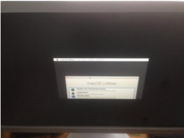
Anscheinend wird die GPU (RX580) nicht richtig erkannt, so dass das Menu nur in einem kleinen Bildausschnitt angezeigt wird.
