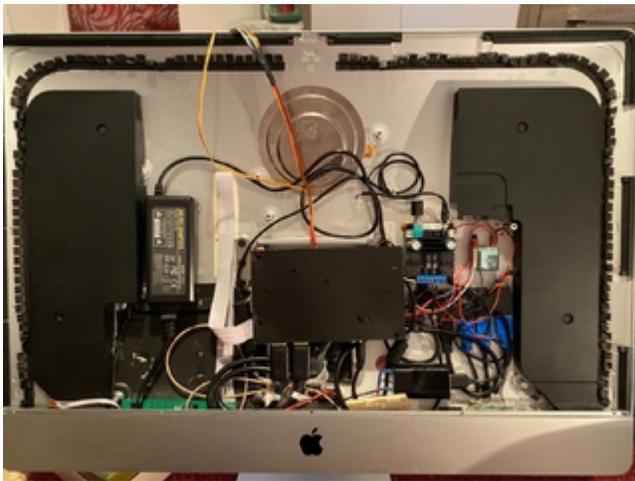
Links unten sieht man wie ich die Driver Board Steuerung gelöst habe LED abgetötet und ober dem Einschaltknopf angebracht, 4 Stifte gedreht die als Knöpfe dienen.
