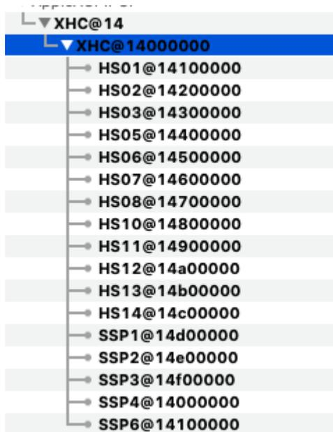
Es fehlen die Ports HS09 und SSP5. Die sind beide dem Hub zugeordnet, dass hier fehlt.
