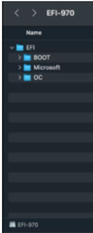
Was passiert sein kann, ist das durch die Win Installation der OC boot eintrag im Bios verschwunden ist. Den kannst du mit dem tool EasyUEFI wiederherstellen, in dem du einen neuen Booteintrag erstellst und auf die bootx64.efi aus dem Ordner EFI/EFI/Boot verweist.
