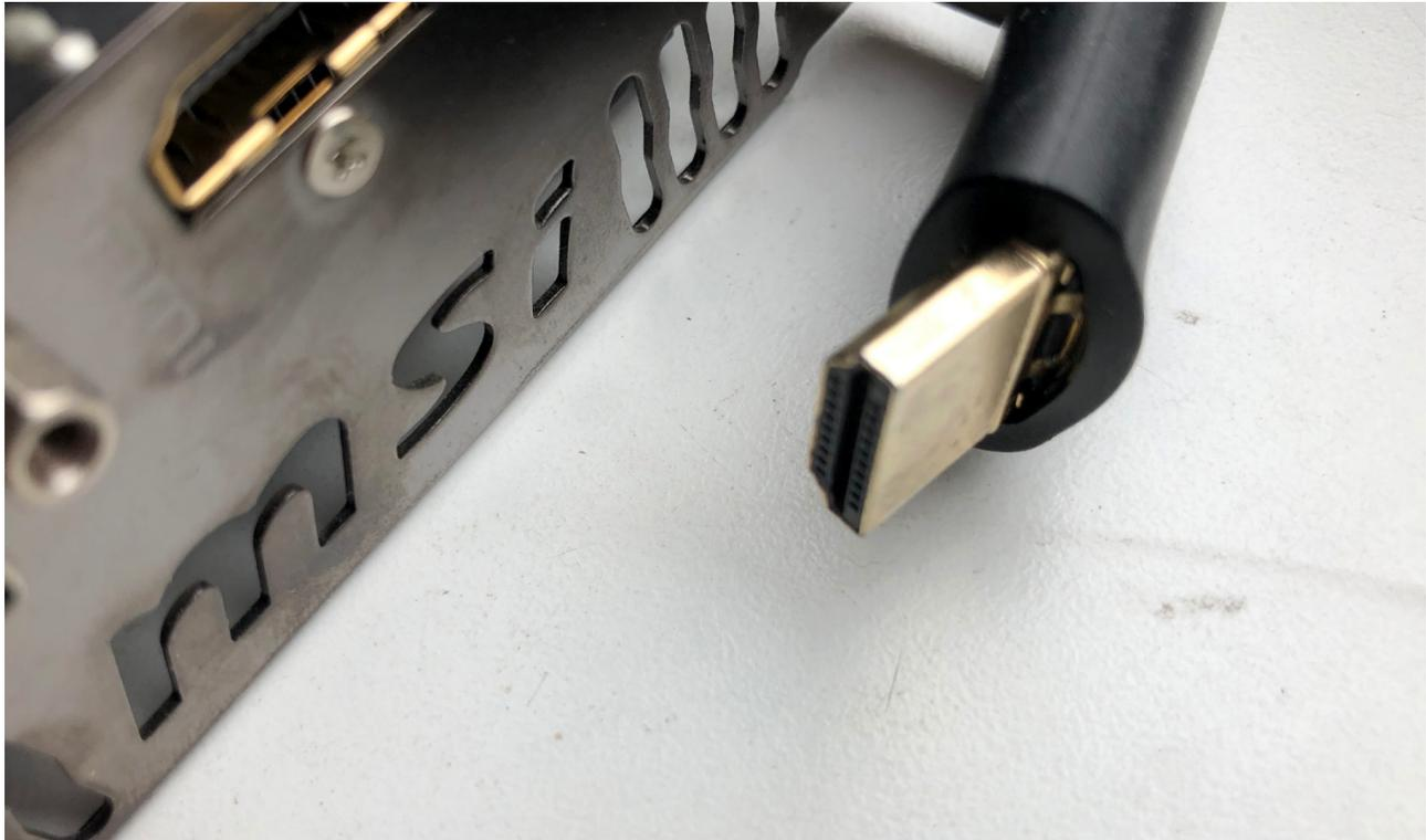
Der Stecker des HDMI-Kabels ist ordentlich verbogen. Und der oft nervende weil unter großen Grafikkarten kaum zu erreichende Sicherungshebel am PCI-e-Slot ist abgebrochen.
