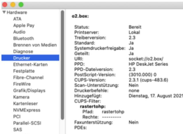
Nach Absenden eines Druckauftrages wird die Drucker-Warteschlange angezeigt, der Drucker rührt sich aber nicht.
