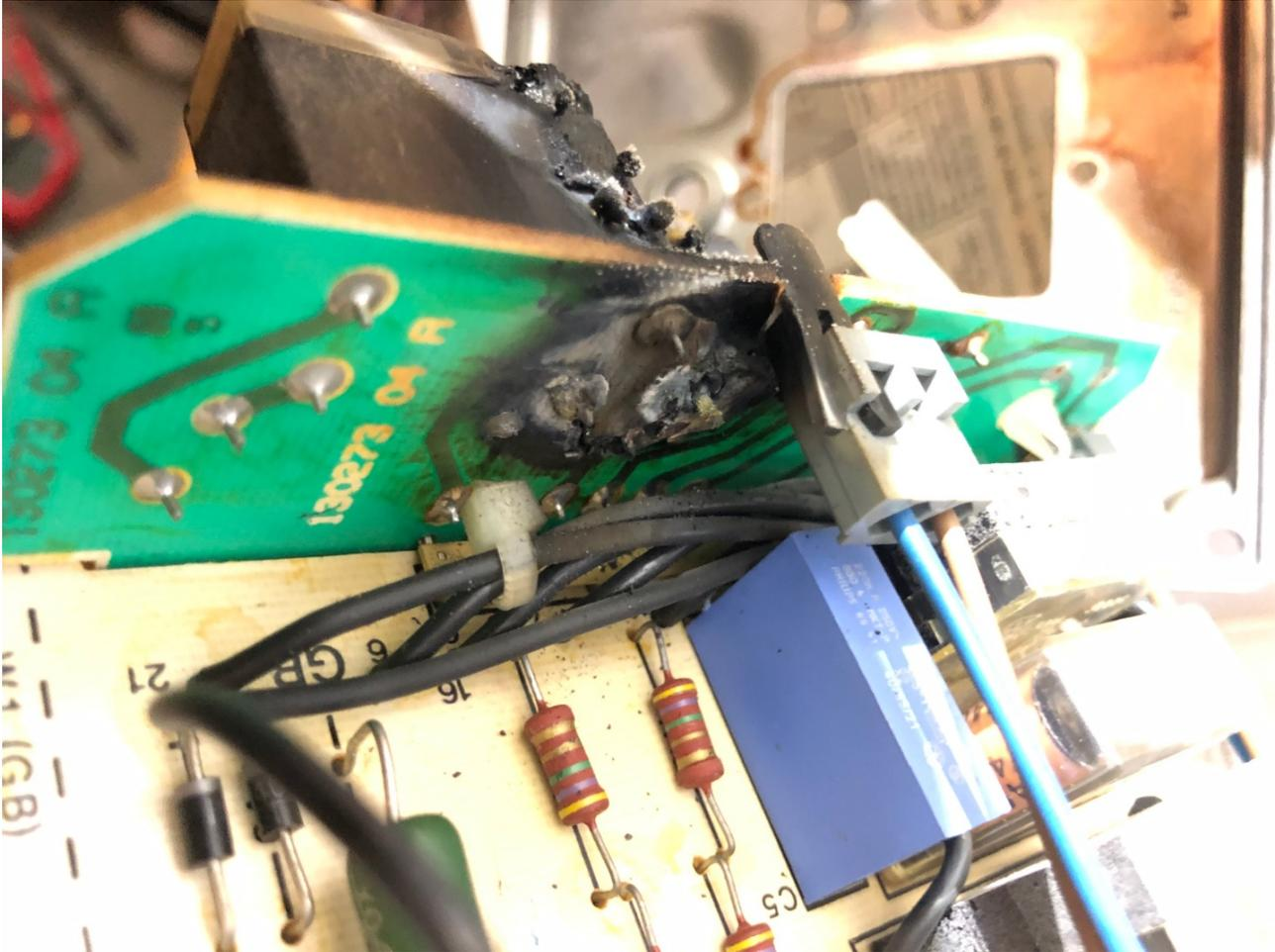
da kann ich auch was beitragen. Das ist das Schaltrelais unserer Vaillant-Heizung aus den 90ern. Relais ausgelötet und Heizungspumpe erst mal anderweitig mit Strom versorgt, bis ein Ersatz Relais besorgt ist. So war das Haus nur einen Tag lang ohne Heizung. Natürlich Sonntag. Aber ich bin super happy. Das alte Schätzchen soll noch laufen, bis wir hier grundsätzlich alles auf Vordermann bringen. Ich will jetzt nicht aus der Not heraus irgend eine Therme kaufen, die grad da ist.
