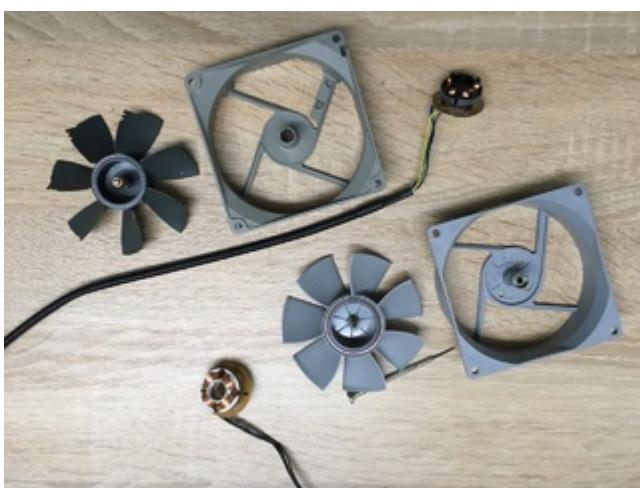
Im Bild erkennt man oben den zerlegten Noctua- und unten den zerlegten G5-Lüfter. Dadurch bleibt die G5-Optik erhalten und die Lüfter lassen sich über das Mainboard - auch im Doppelpack - steuern. Natürlich darf bei den Lüfterpaaren das Tacho-Signal nur von einem Lüfter angeschlossen werden, sonst kann das Mainboard damit nichts anfangen. Und natürlich beeinflusst die Noctua-Spule das Geräuschprofil des G5-Lüfters nicht.
