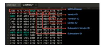
Bei den problematischen I225-V der Gigabyte-Boards, waren Subsystem-ID und Subsystem-Vendor-ID nicht korrekt hinterlegt. Bei Subsystem-Vendor-ID z. B. war auch die Vendor-ID (Intel) und bei Subsystem-ID nur Nullen anstatt *E000* eingetragen. Das Ändern dieser Werte hatte jedoch keinen Einfluss auf die Funktionalität.
