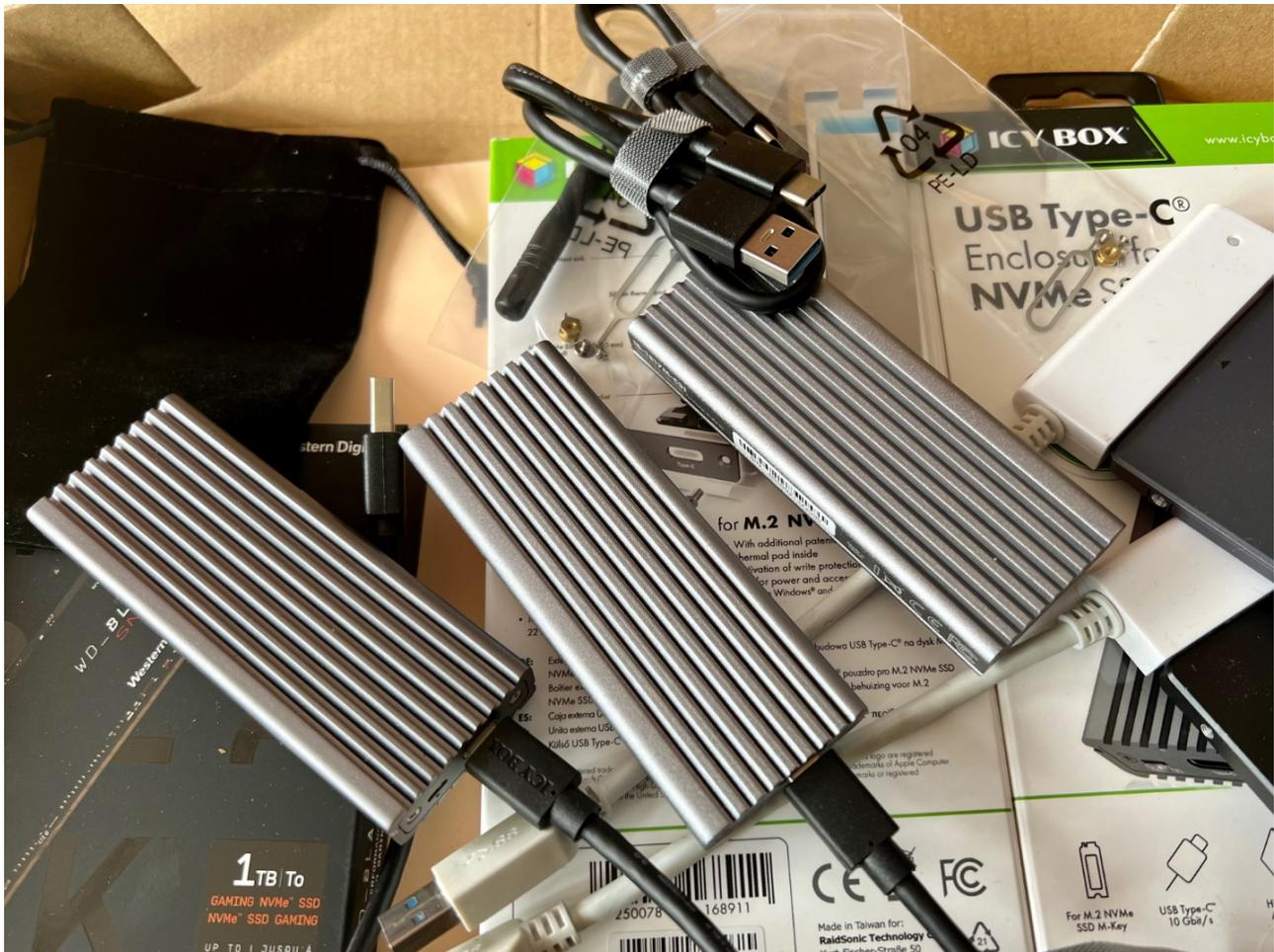
aus den SSDs sind M2-NVMe geworden, das passende Metall-Gehäuse mit USB-C- und USB-3-Anschluss von Icy Box (IB-1817M-C31) habe ich mir in mehrfacher Ausführung bei meinem lokalen Computer-Händler besorgt (Ja, so etwas gibt es noch!).
