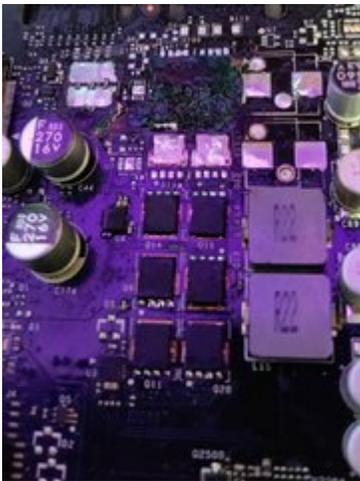
2 der Spulen wurden entfernt (da ohne die MOSFETs sowieso nicht gebraucht), alle MOSFETs der entsprechenden Phasen + MOSFET Treiber. Die oberen Pads sind auch komplett weg, da waren die MOSFETs zu stark eingebrannt + ich habe die Pads dann entfernt, da es auch nicht mehr so ging. Das Grüne ist Lötstopplack.
