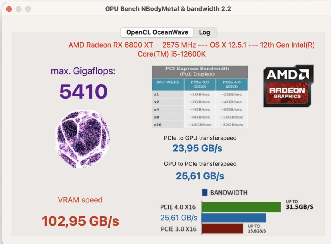
Bei gleicher Karte in nem **PCI 3.0** Slot - statt PCI 4.0 - sinkt die Transferspeed nochmal deutlich von den 26 GB/s auf nur 9 bis 13 GB/s.
