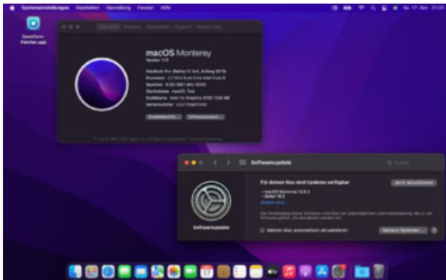
Damit ich das MacBook auch mit MacOS Ventura 13.1 nutzen kann kommt nun der „OpenCore Legacy Patcher“ zum Einsatz. Was dieser macht ist. Er installiert „OpenCore“ als neuen Bootloader (Bootloader das Programm das das OS beim Start lädt) & konfiguriert diesen so, das er die Hardware Infos eines noch von Apple unterstützten Modells ans OS sendet, damit dieses dann das Update zulässt.
