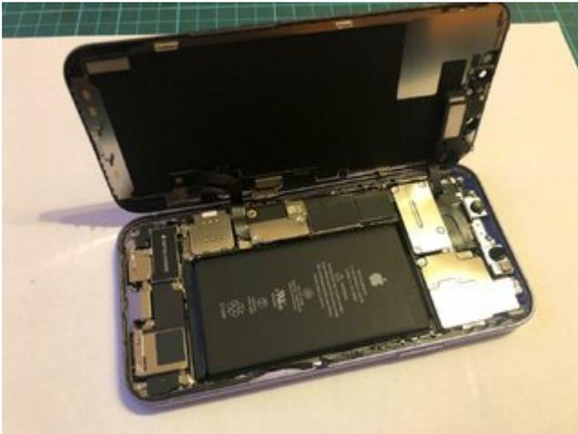
Das Display ausgebaut. Unten liegen der neue Kartenleser so wie die Abdeckbleche unter denen die Stecker fürs Display & Akku sich befinden.
