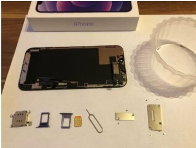
Nun ist der alte Kartenleser drann. Rechts & Links müssen die beiden Abdeckbleche abgeschraubt werden. Darunter liegen dann die Schrauben mit denen der Kartenleser selber befestigt ist. Genau wie der Steckverbinder mit dem der Kartenleser mit dem LogicBoard verbunden ist.
