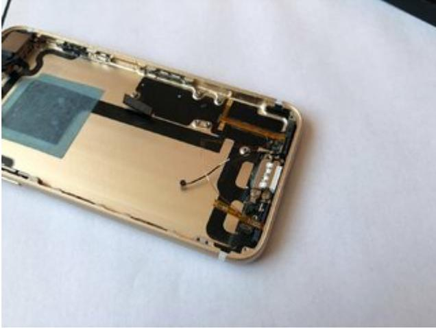
Die LED Flex Kabel sind durch 2 sehr dünne Kabel mit einander verbunden. Dünner als ein Haar. Diese werden normalerweise genutzt um damit Magnetspulen zu wickeln.
