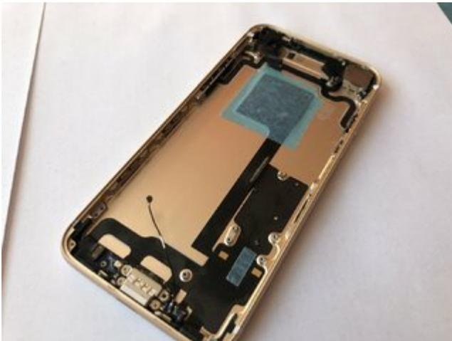
Um die Lautsprecher LED Flex ein zu bauen musste ich die Gummidichtungen hinter den Lautsprecher Öffnungen rausheben. Dabei muss man aufpassen, da an diesen die beiden Mikrofone befestigt sind, deren Kabel schnell abreißen können. Es war garnicht so einfach die LED Strips daran vorbei in die Öffnungen zu bekommen.
