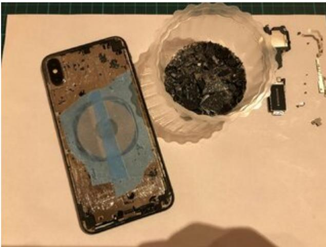
Das neue Rückglas zum Schutz mit Klebestreifen abgeklebt & auf Kleber auf das Gehäuseblech bereits aufgetragen.
