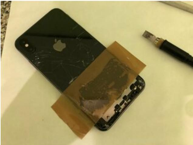
Der Stand nach ca 2 Stunden. Das Glas immer wieder & wieder mit Heißluftföhn erwärmt & den Kleber an zu lösen & aufpassen das ich mir nicht die Finger verbrenne oder mich selber mit dem Skalpell punktiere. Das kupferfarbene ist die Dratlosladespule. Diese ist von Innen direkt aufs Gehäuseblech geklebt, gerade mal ca 2-3 Blatt Papier dick. Auch bei der musste ich echt aufpassen die Spule nicht zu beschädigen.
