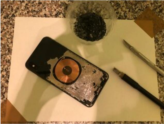
Nach insgesamt 2:30 Stunden das Glas entfernt & noch etwas nacharbeiten nötig. Die Ladespule hab ich zum Schutz mit Klebeband abgeklebt.
