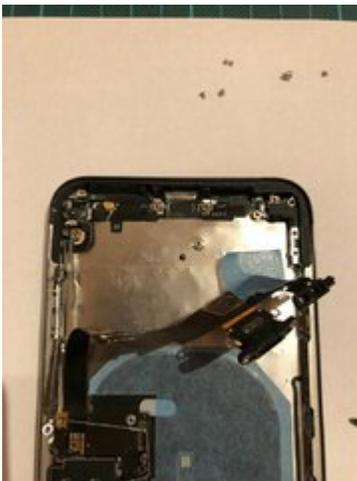
Hier hab ich das alte Kabel schon ausgebaut. Bei verkleben Teile ist es immer ratsam die Bauteile mit einem Föhn zu erhitzen um den kleben an zu lösen. So bekommt man die Teile leichter raus & die Gefahr sie zu beschädigen ist geringer.
