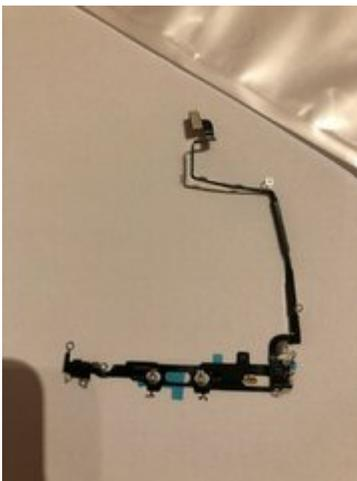
Das besondere, ab dem iPhone X hat Apple im unteren Bereich 2 Flexkabel verwendet, die übereinander geklebt sind. Also erstmal Kleinteile ausbauen & dann vorsichtig das obere Kabel ablösen & zur Seite kleben um an das untere Kabel drann zu kommen.
